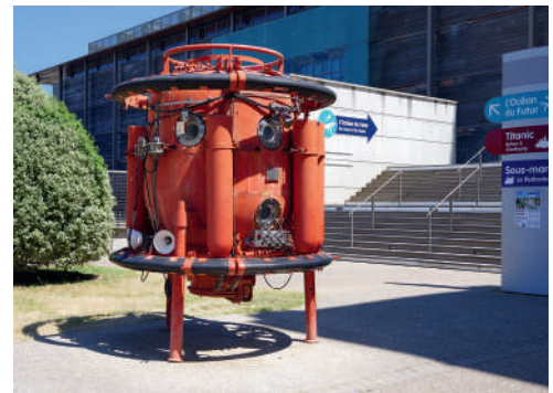
ARBEITSINSTRUMENT: Ein rostrotes Industrietauchgerät der französischen Firma Comex. Damit wurden Instandhaltungsarbeiten auf dem Meeresboden durchgeführt
