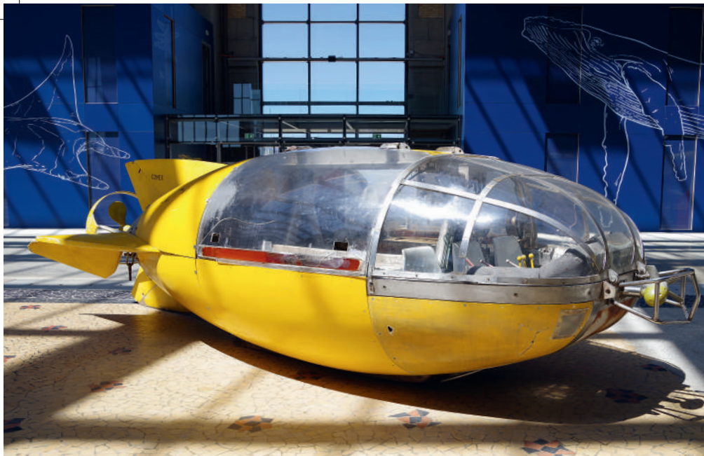
ZWEISITZER: Ebenfalls von der Firma Comex stammt das Tauchgerät Globule , das zur Überwachung von Bohrungen und zur Ausbildung diente
